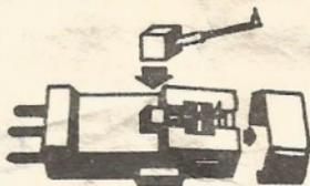
Vložka má tři samostatné vývody. V rameni přenosky je uchycena v konektoru, nebo může být uchycena v držáku s roztečí upevňovacích otvorů 12,7 mm. Levý kanál je označen písmenem L a pravý písmenem R.
